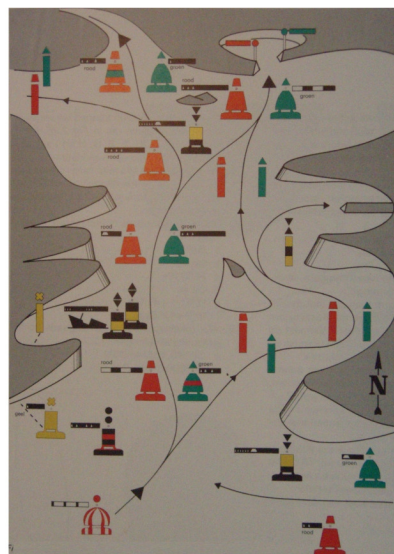
Schema soorten boeien (uit: Kustnavigatie Hollandia, 1997)
